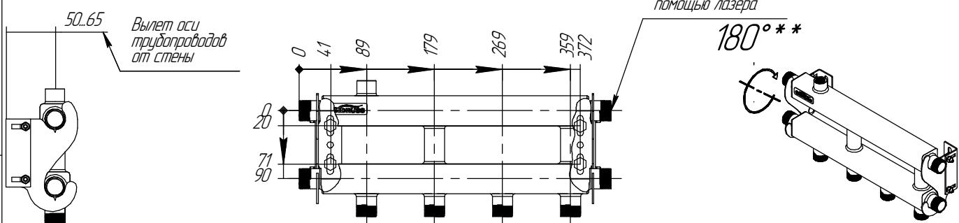
\*\* Для верхней подводки потребителей допускается перевернуть коллектор на 180° по горизонтальной оси
