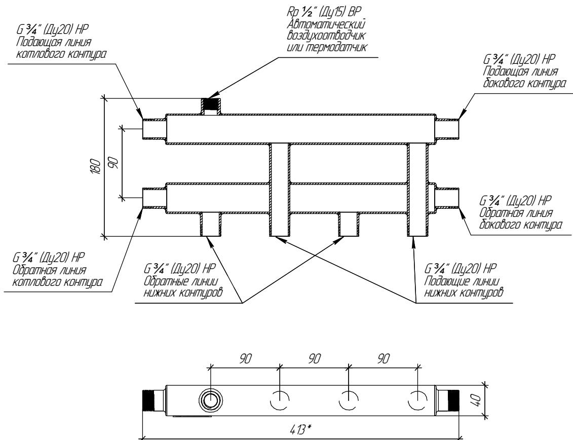
\* Используется для разметки отверстий кронштейнов
